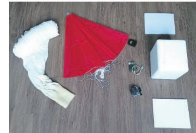
**Verschiedene Teile der Ausrüstung:** Ballonhülle, Fallschirm, Messeinheiten und GPS-Gerät
